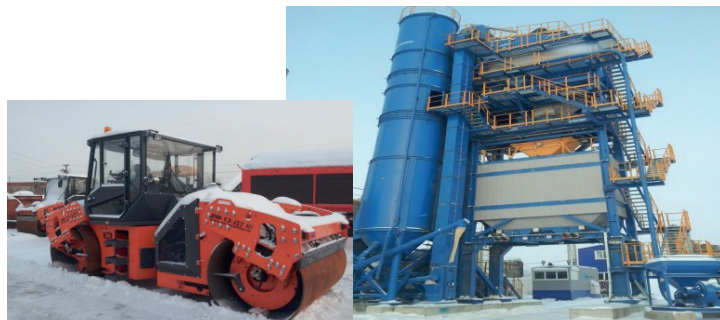
Неиспользуемое оборудование: каток и технологический комплекс для производства асфальтобетонной смеси и битумных эмульсий
